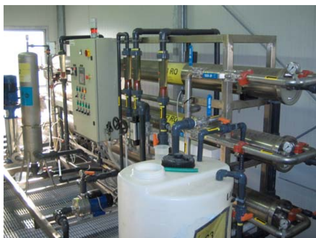
Figura 11. Unità di ultrafiltrazione con sistema a membrane a spirale avvolta.
