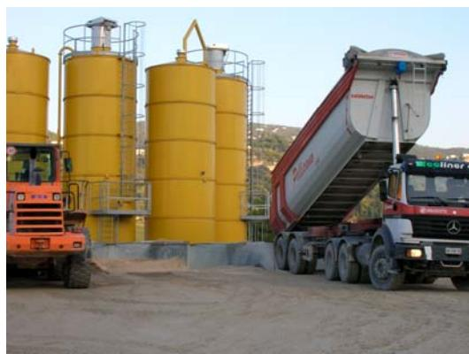
Gli impianti hanno in totale una capacità di stoccaggio inerti di circa 500 metri cubi, e sono alimentati direttamente nelle tramogge di stoccaggio in pesa; l'alimentazione può essere effettuata tramite pala o direttamente tramite scarico dei bilici.
