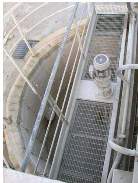
L’acqua, con le pezzature più fini degli inerti (max 0,3 mm.) e del cemento, caduta nell’antescritta vasca circolare di stoccaggio a tenuta stagna, viene tenuta costantemente in movimento mediante appositi agitatori meccanici che evitano la sedimentazione dei fini sospesi, così che anch’essa possa essere recuperata completamente nel processo di produzione del calcestruzzo, mediante specifico impianto idraulico.
