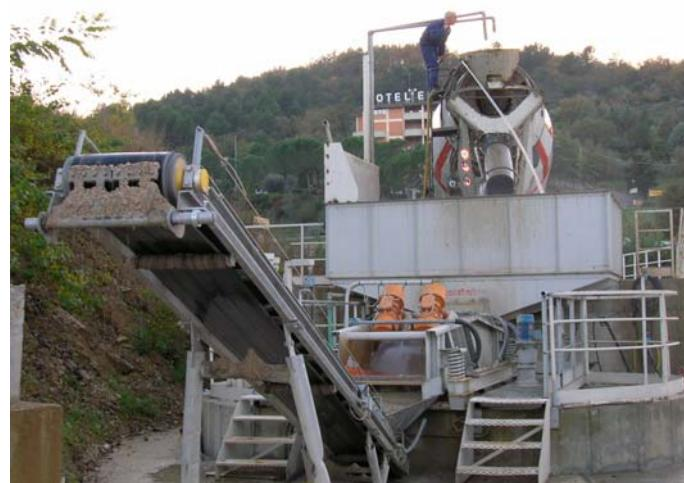
Operare con un sistema di riciclaggio significa recuperare in modo totale gli aggregati e riutilizzare le acque di lavaggio che, ricche di finissimi e di cemento in sospensione, opportunamente dosate nel confezionamento del calcestruzzo ne aumentano la
