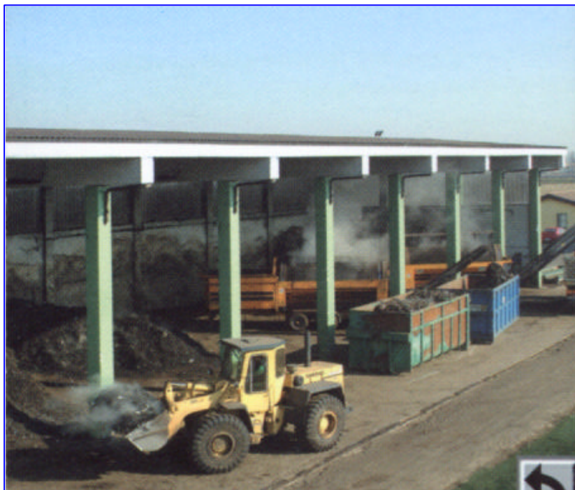
Figura 16 Momento di rivoltamento e trasporto dei cumuli.
