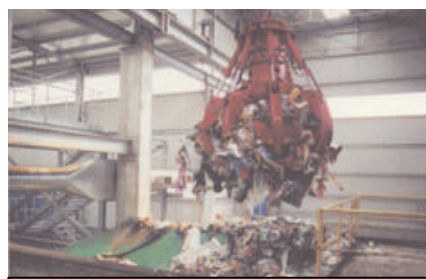
Figura 22 Benna del carro ponte operativa nella fossa
