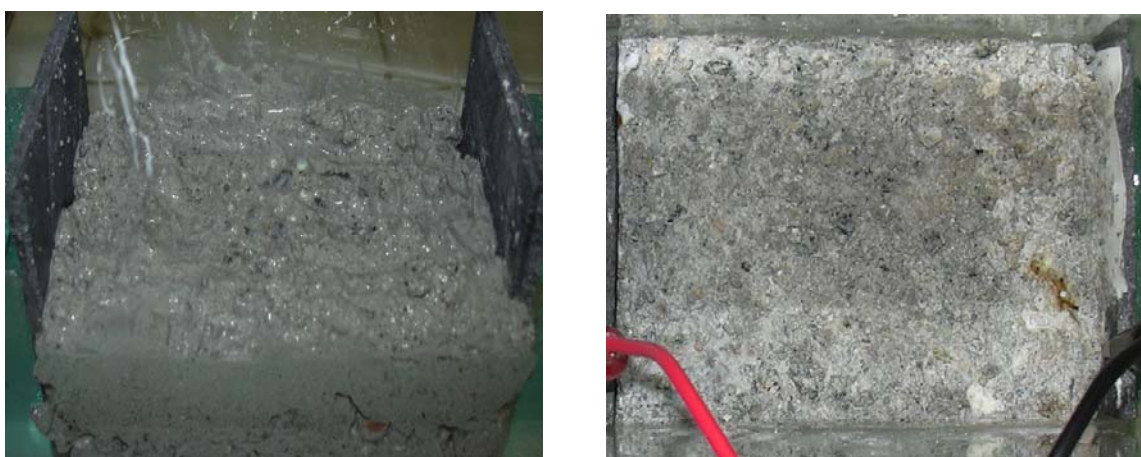
fig. 5.10: umidità visibile nelle bottom ash prima e dopo il trattamento
