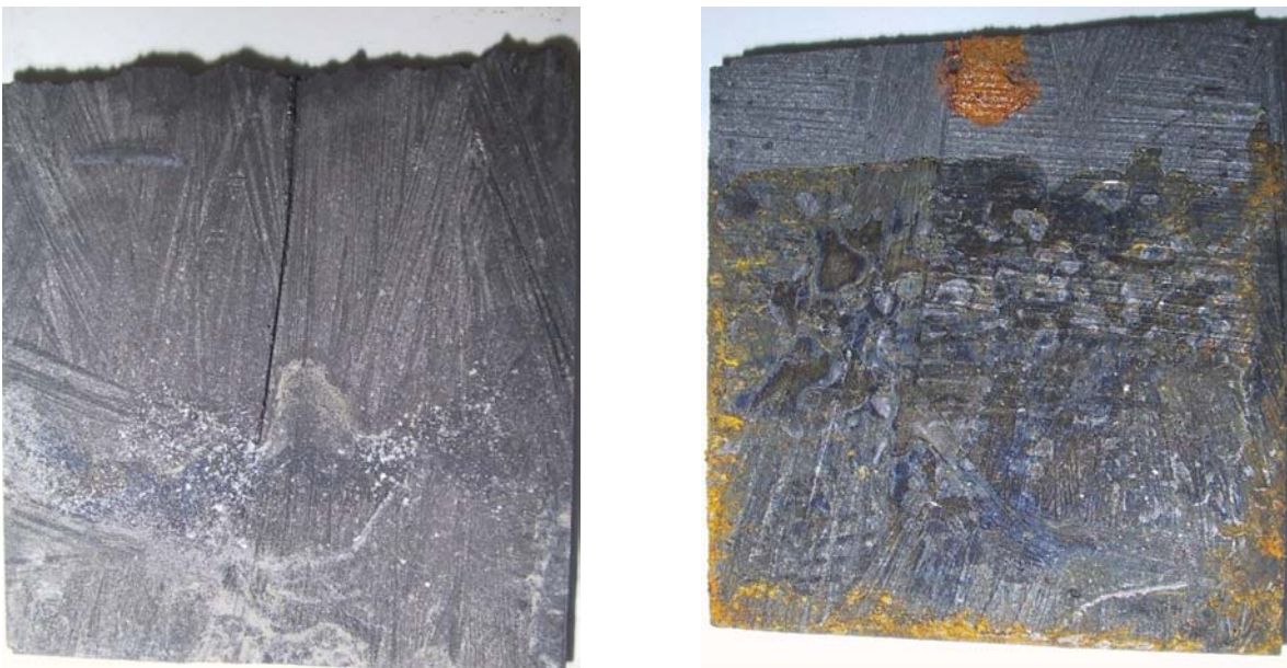
fig 5.8 : piastre in grafite utilizzate come catodo e anodo nella seconda prova
