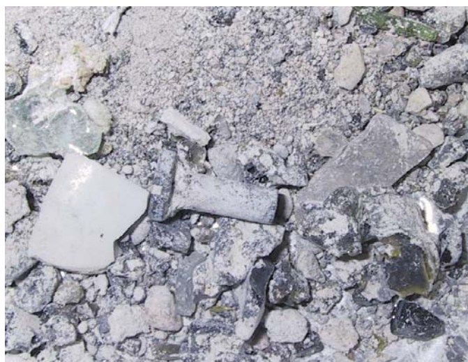
fig 5.4 : vite ritrovata nella parte centrale della cella che ha veicolato parte dei cationi verso di se.
