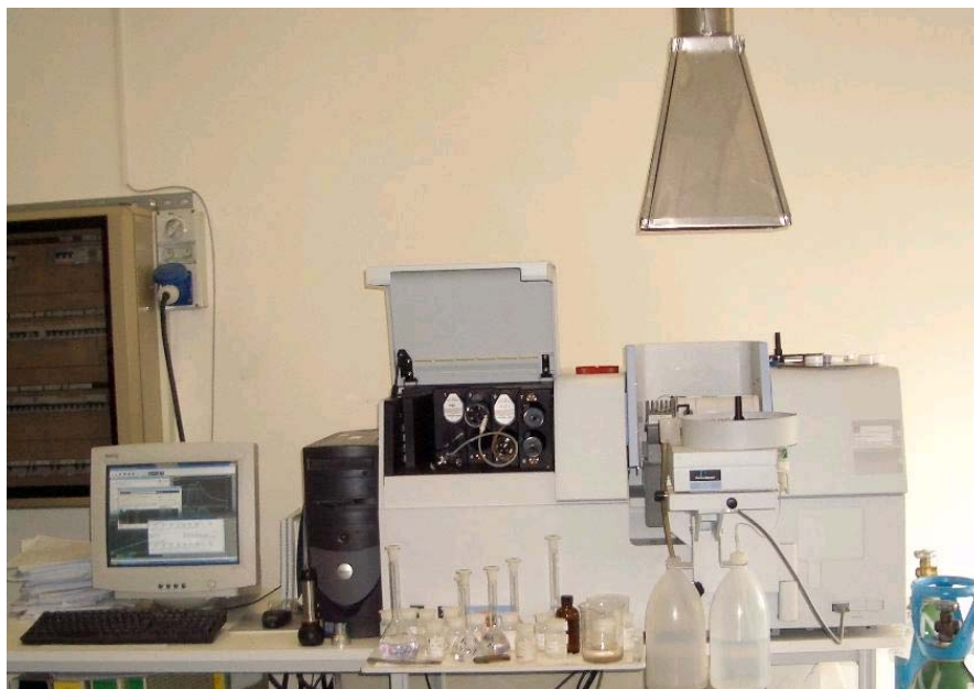
Fig. 4.1 Fornetto di grafite ad assorbimento atomico.
