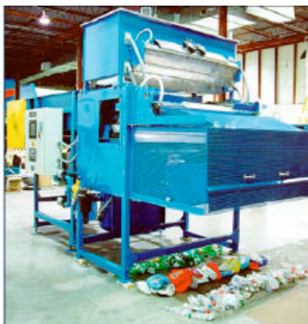
Foto 6: macchina per separazione spettroscopica di materiale plastico.
