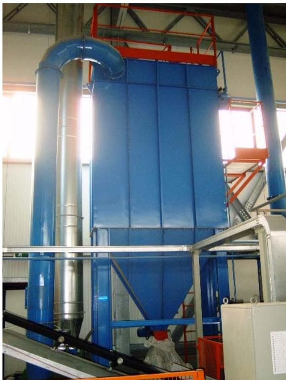
*Figura n° 4.4 : Abbattimento polveri da silos stoccaggio M.P. dell'impianto mattonelle*
