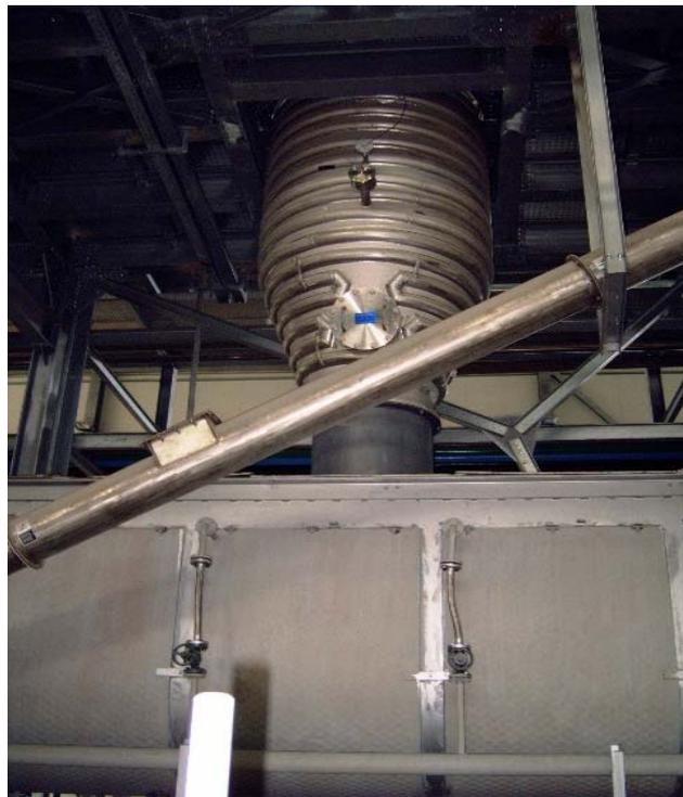
*Figura n° 3.10 : Evaporatore acqua*
