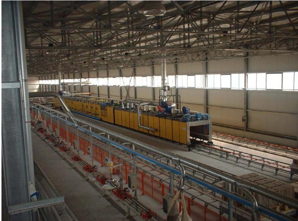
*Figura n° 7.2 : Forno a tunnel per la cottura delle mattonelle*
